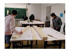
Am Anfang entstand der Unterstand auf der Zeichenplatte in mehreren Ansichten. Dann folgte der Aufriss mit Zimmererbleistift, Winkel und Meterstab auf das Holz.
